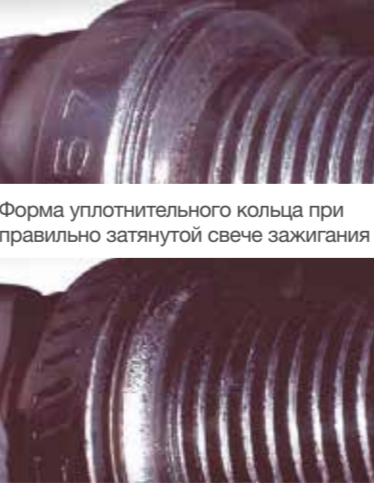
Форма уплотнительного кольца при недостаточно затянутой свече зажигания
